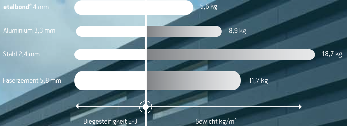
Vergleich von Dicke und Gewicht bei identischer Biegesteifigkeit
