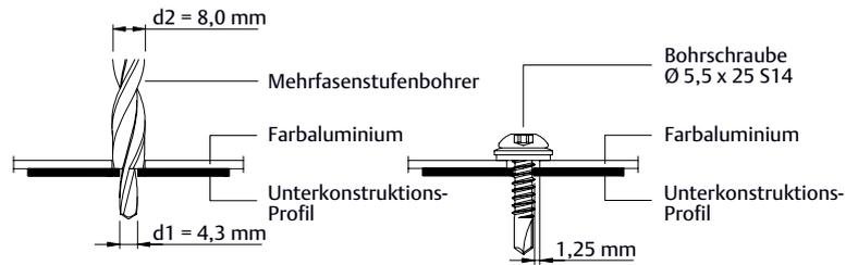
Der Abstand (a, b) der Befestigung vom Plattenrand muss mindestens 25 mm betragen. Bei höheren Belastungen sind entsprechend geringere Befestigungsabstände zu wählen. In jedem Fall ist ein statischer Nachweis erforderlich.
